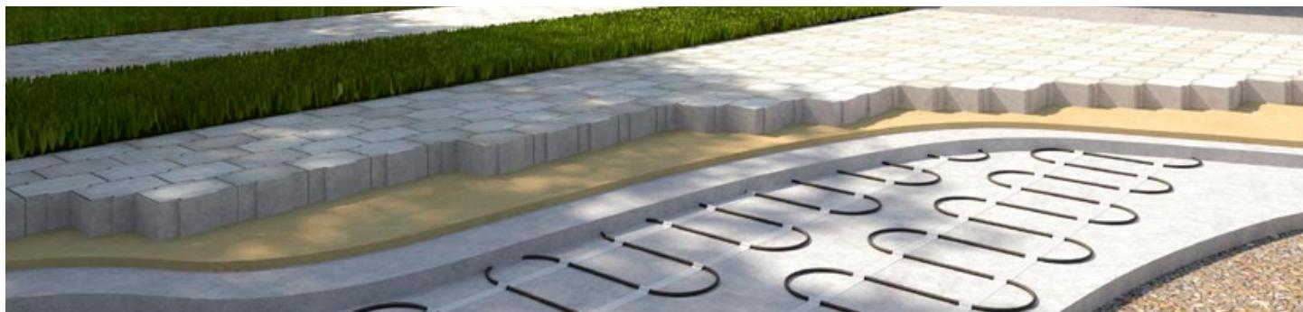
Folia de încălzire ECOFILM folosește tehnologie de ultimă oră (produse în UK de FLEXEL) pentru a încălzi suprafețe întinse. Aceste sisteme de încălzire sunt compuse din folii de PVC laminate între care sunt inserate benzi din grafit (carbon), fâșii din cupru pentru alimentare și accesorii. Vă oferim folia încălzitoare ECOFILM în 3 versiuni: folia de încălzire prin pardoseală ("F"), folia de încălzire prin tavan ("C") și folia pentru dezaburirea oglinzielor.
